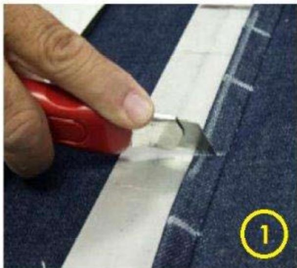
En prenant soin de protéger la sellerie avec une règle ou une pièce métallique, pratiquer des encoches au cutter pour le passage des crochets d'élastique
