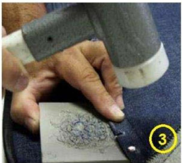
Après en avoir recourbé les extrémités des tiges métalliques en formant une boucle, fixer en rivetant à chaque extrémité
